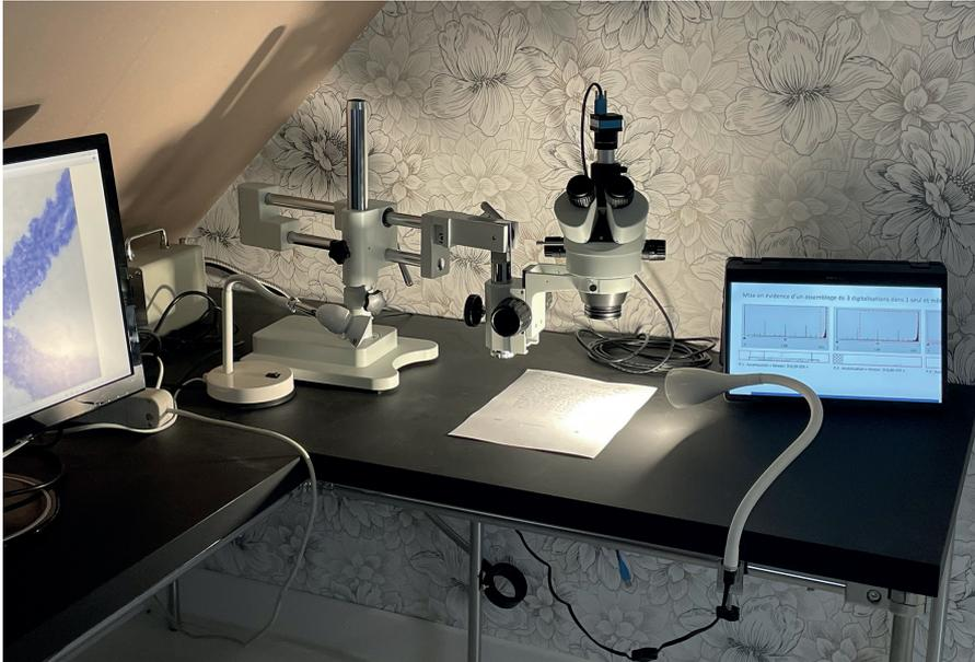
Photographie de laboratoire - Microscope trinoculaire stéréo avec anneaux lumineux à fibre optique LED supportant une caméra sensible aux rayonnements infrarouges (IR) et accompagné de diverses sources lumineuses (tungstène, halogène comprenant blanc chaud, froid, neutre, LED) permettant plusieurs angles d'incidences dont la lumière rasante.
